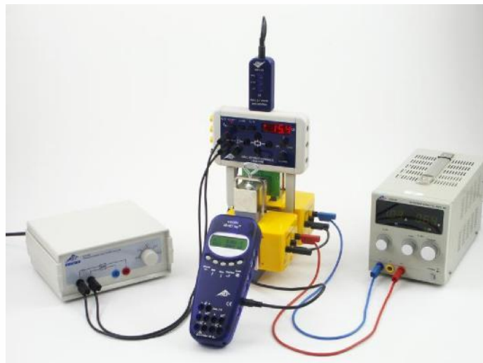
Fig. 9 Experimentieraufbau Hall-Effekt mit homogenem Magnetfeld
