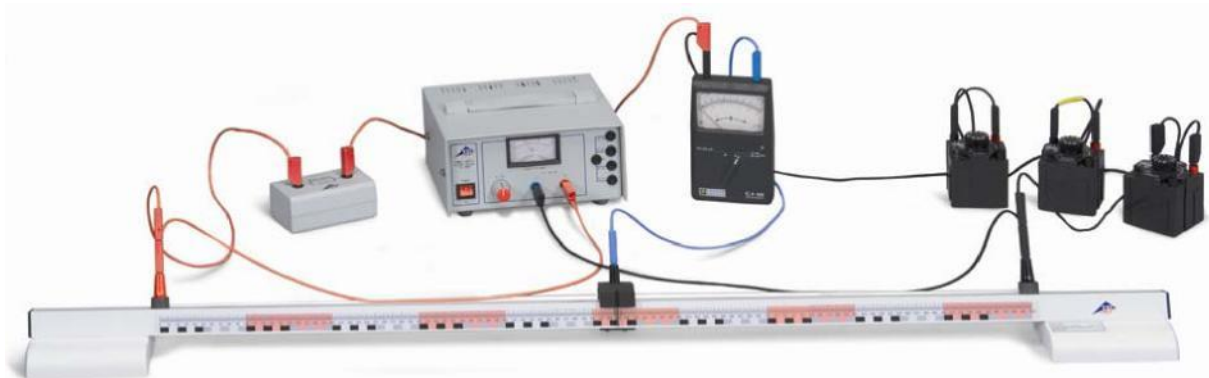
Fig. 2 Bestimmung eines Widerstands in einer Wheatstone'schen Brückenschaltung
