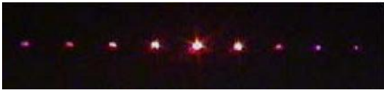
Fig. 7 Franja de reflexão de uma grade
