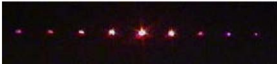
Fig. 7 Structures de diffraction d'un réseau de
