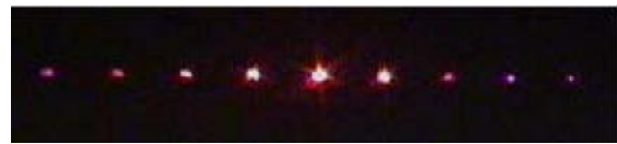
Fig. 7 Modello di diffrazione di un reticolo
