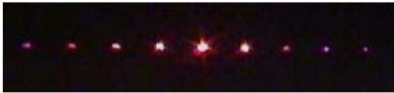
Fig. 7 Patrón de difracción de una rejilla
