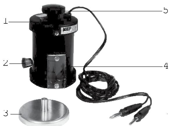
Die Einstrahlleuchte dient der Durchführung von Demonstrationsversuchen zur geometrischen Optik auf magnethaftenden Tafeln (U14600).
