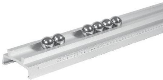
Stahlkugeln geeignet für Versuche zum elastischen und inelastischen Stoß in einer Laufschiene.
