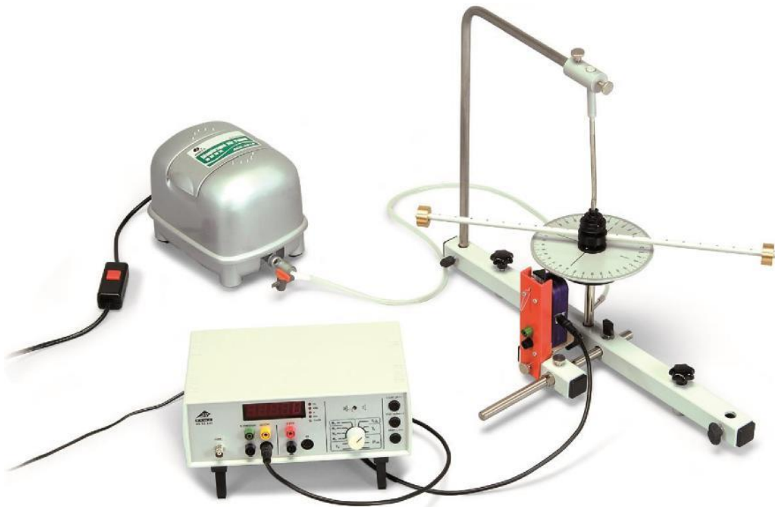
Fig. 2 Experimenteller Aufbau zur Bestimmung des Trägheitsmoments einer Hantelstange mit Zusatzmassen mit dem Laserreflexsensor (1001034) und dem Digitalzähler (1001032 bzw. 1001033)
