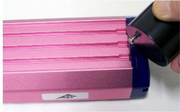
Fig. 22 Einsetzen der Zusatzmasse in die Nut auf der Oberseite des Fahrbahnwagens
