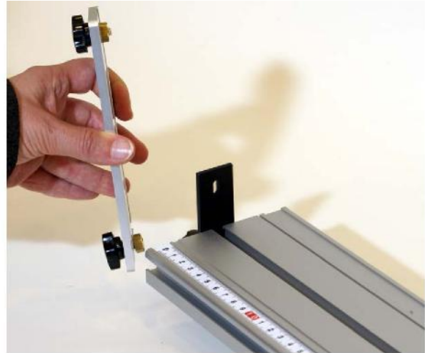
Fig. 16 Einsetzen des Halters für Lichtschanke in die seitliche Nut der Rollenfahrbahn
