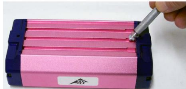
Fig. 24 Einsetzen des Unterbrechers in die Nut auf der Oberseite des Fahrbahnwagens
