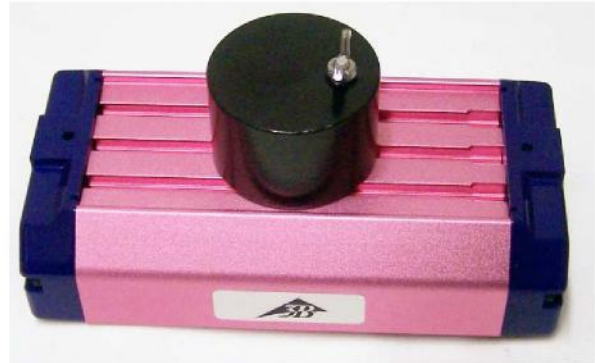
Fig. 23 Fertig montierte Zusatzmasse
