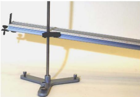
Fig. 20 Fertig montierte Muffe für Stäbe in der seitlichen Nut der Rollenfahrbahn
