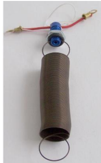
Fig. 2 Federbaugruppe mit Schraubenfeder
