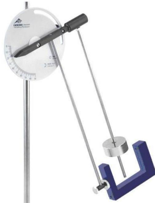
Fig. 1 Variables-g-Pendel mit Haltevorrichtung und Lichtschranke
