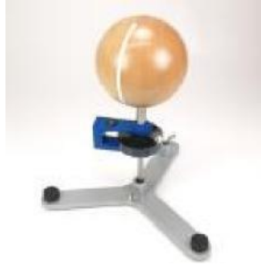
Fig. 6 Bestimmung des Trägheitsmomentes einer Kugel
