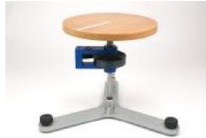
Fig. 4 Bestimmung des Trägheitsmomentes einer Holz-scheibe
