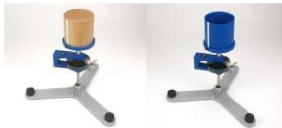
Fig. 5 Vergleich der Trägheitsmomente von Zylindern
