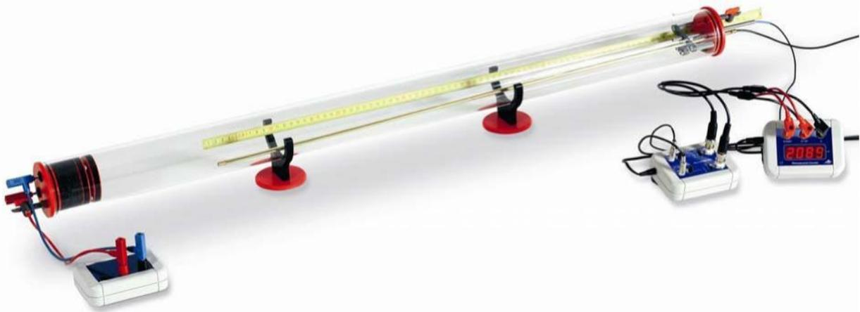
Fig. 1 Bestimmung der Schallgeschwindigkeit aus der Laufzeit eines Schallimpulses
