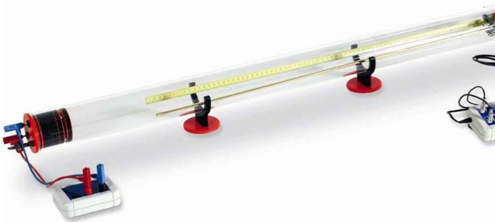
Fig. 1 Experimenteller Aufbau mit dem Kundt'schen Rohr
