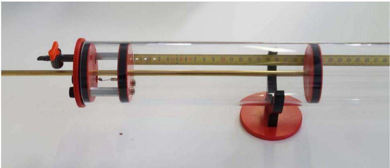
Fig. 1 Mikrofonsonde mit aufgeschraubter Sondenscheibe
