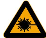
Dieses Schild warnt dich vor intensiver Laserstrahlung. Sie kann Schäden an biologischem Gewebe insbesondere dem Auge verursachen.
